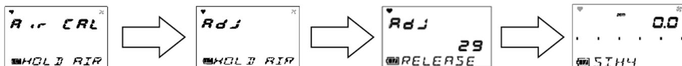
**警告:新鮮な大気中以外でエア校正を行うと、正しい校正が行えずガスが漏洩した場合に危険です。**
